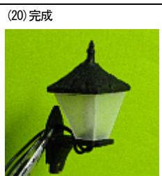
(20) 完成 (19)の乾燥後電球台にはめて完成です。12Vの電源につなぐと点灯します。
