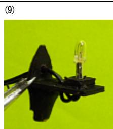
(9) コードを今度は水平台中央の孔を通して上に戻し、最後に背板の孔から後方に抜きます。
